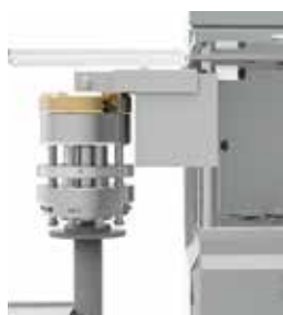
Sistema de extracción de cabezal Turret head removal system
