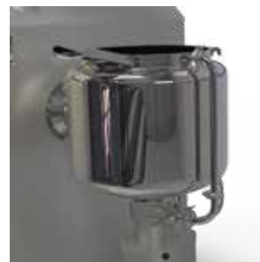
Recipiente con camisa de calefacción, refrigeración y aislamiento Isolated and dual jacket bowl (heating and cooling)
